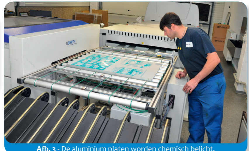
Afb. 3 - De aluminium platen worden chemisch belicht.
